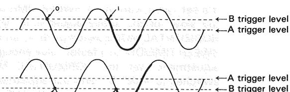
iii) A SLOPE: -, B SLOPE: +
