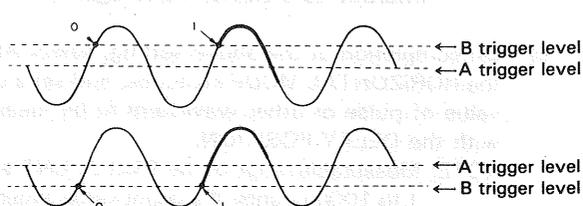
iv) A SLOPE: -, B SLOPE: -
